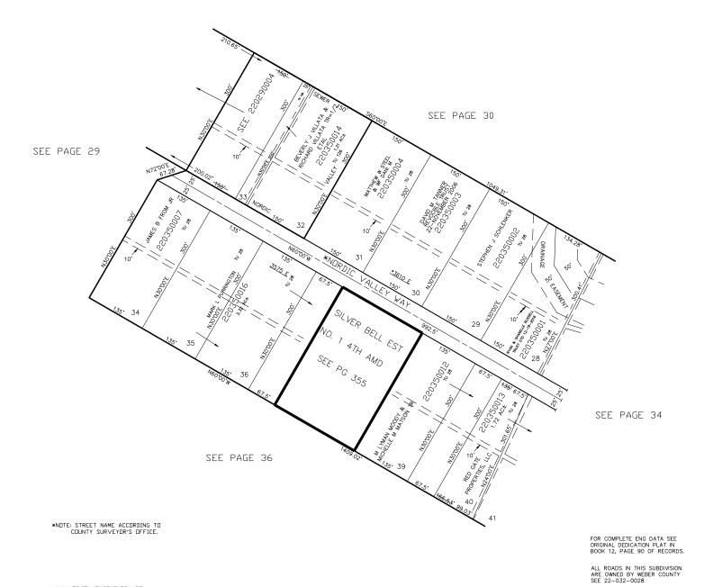
ALL UTILITY EASEMENTS ARE 10 FEET WIDE. THE DRAINAGE EASEMENT IS 100 FEET WIDE.
